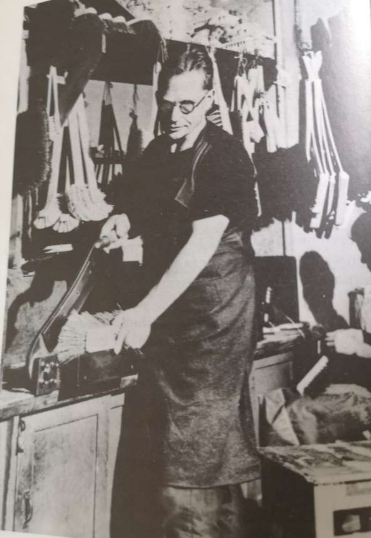
Harjan tasaaminen harjasaksilla on tarkkuutta ja varovaisuutta vaativa työvaihe. Kuva Pengerkadun harjaverstaassa 1950-luvulla. (Näkövammaisten Keskusliitto ry)
